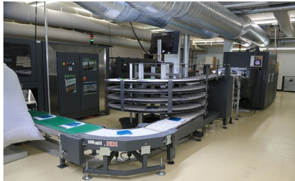
Die automatisierte Tecna Libra 800 stellt klebegebundene Bücher und Broschüren her, die von Exemplar zu Exemplar format- und umfangvariabel sein können. Hier laufen Produkte durch den Abkühlurm, bevor sie dem variablen Dreischneider Libra VT (rechts) zugeführt werden.
